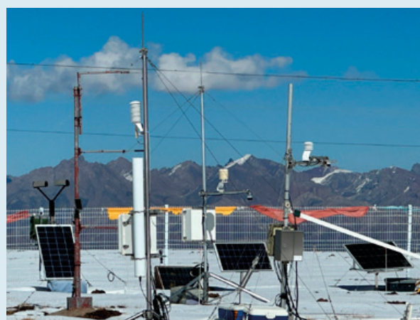
Exemple d'une station hydrométéorologique automatisée de l'INARCH, déployée dans le bassin de haute montagne des monts Qilian, Chine
