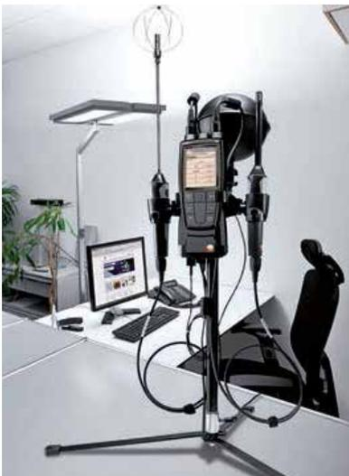
L'équation proposée par Fanger permet de calculer la valeur du PMV et du PPD. Ces grandeurs peuvent être mesurées sur site par des appareils de mesure.
