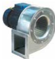
Ce sont des ventilateurs dans lesquels l'air rentre dans la roue dans une direction axiale et en sort dans une direction essentiellement parallèle à un plan radial. Ces ventilateurs sont les plus utilisés dans les systèmes de CVC. Ils sont essentiellement utilisés quand l'air doit être véhiculé à travers un
